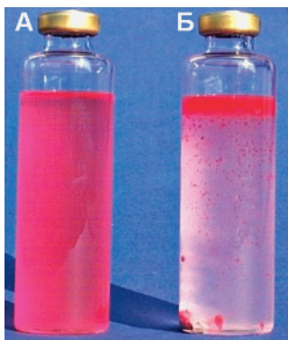
Рис. 3 А — ПАВ — фильтрация невозможна. Быстрое истощение жидкости. Б — МРС®-Технология. Загрязнения выпадают в осадок. Фильтрация позволяет регенерировать промывочную жидкость
